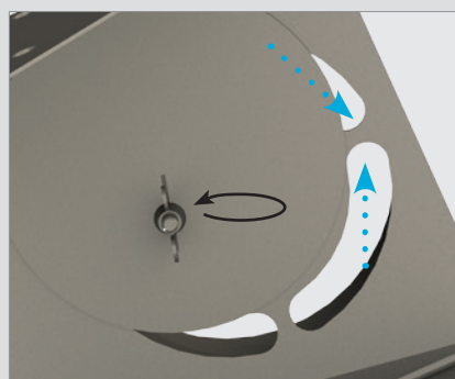
A 87°-os bekötő könyök idom falikonzollal, melynek aljában egy excentrikusan behelyezett állítható nyílás biztosítja a szabályozható égési levegő beáramlását.
