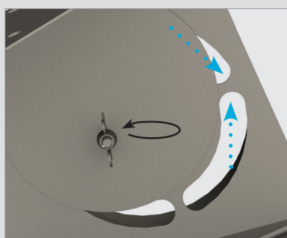
Από την καμπύλη στερέωσης 87°, όπου ο εκκεντρικά τοποθετημένος δίσκος επιτρέπει τη συνεχή ρύθμιση της ροής μάζας του αέρα καύσης.
